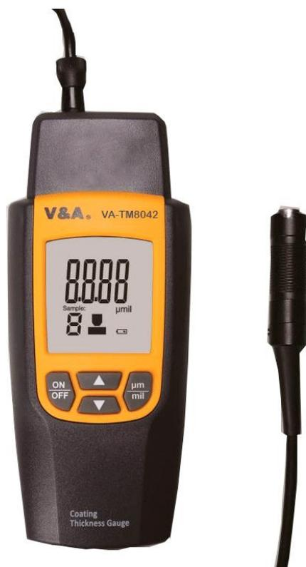
Толщиномер VA-TM8042 предназначен для измерения толщины немагнитных покрытий (лаки, краски, пластик, эмаль, цинк, хром и т.п.), нанесенных на металлическое магнитное основание (сталь, чугун и пр.).
